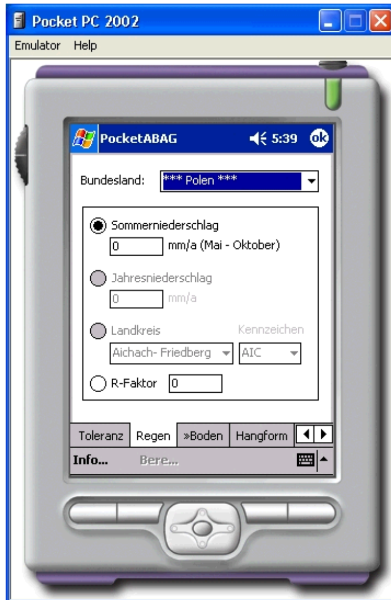
Abb. 1: Erscheinungsbild von PocketABAG am Beispiel der Maske zur Bestimmung der Regen-Erosivität
